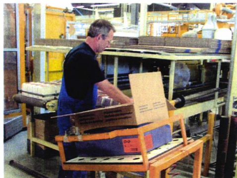
Figuur 31 Draaien met de rug bij repeterende inpakwerkzaamheden
