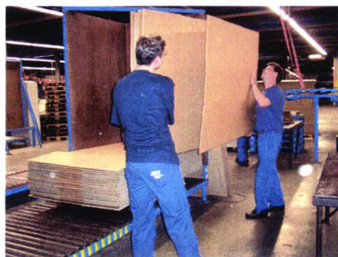
Figuur 20 Samen tillen voor een betere houding en reductie van het tilgewicht
