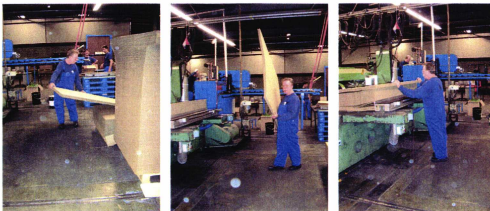
Figuur 7 Overtilen stapels karton bij invoer machine, waarbij soms ook een gedraaide houding voorkomt
