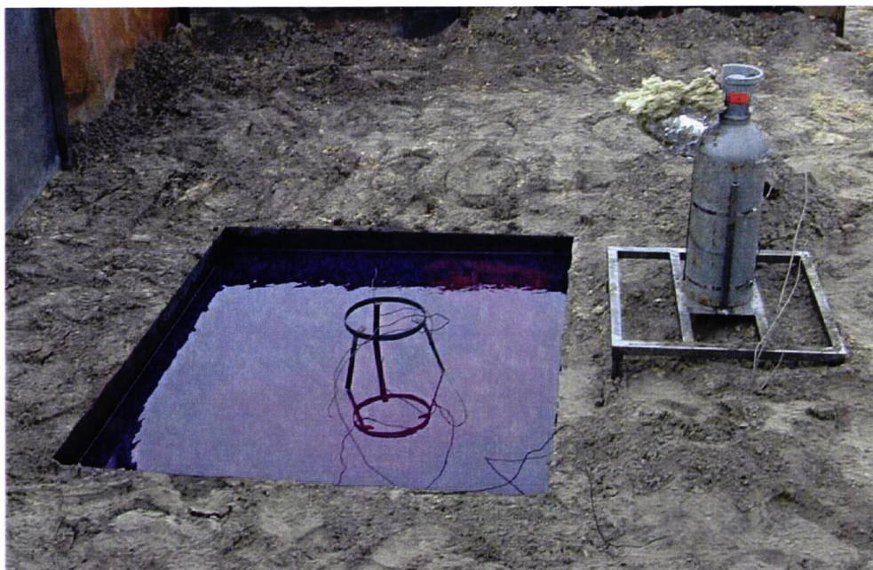
Figuur 2-2 Opstelling CO 2 cilinder tijdens test 1.
