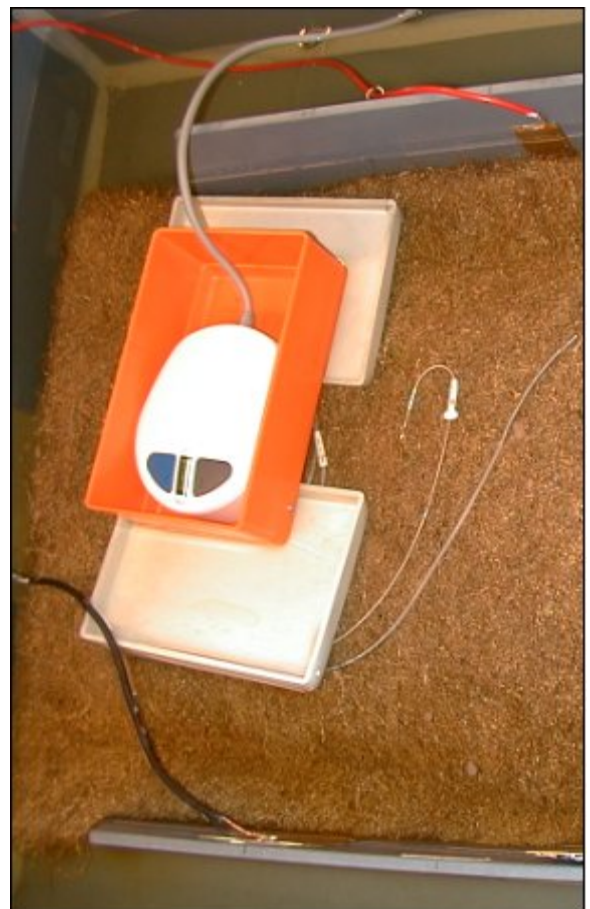
Defibrillator in zoutoplossing ter simulatie van het menselijk lichaam.
