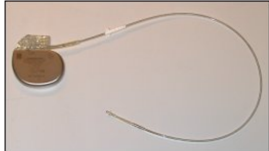
Implanteerbare pacemaker met lead/wire/electrode.
