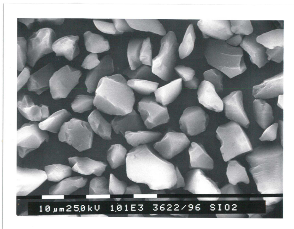
Afbeelding b4.7 SEM-opname van SiO 2 -dragermateriaal (1000 maal vergroot).
