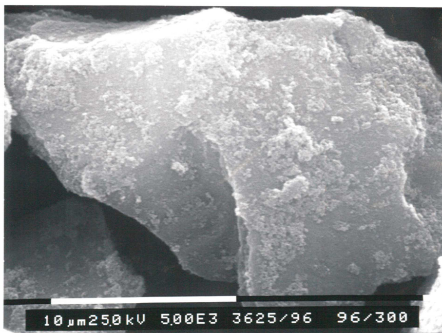
Afbeelding b4.10 SEM-opname van ongebruikte SiO 2 /TiO 2 -deeltjes (5000 maal vergroot).
