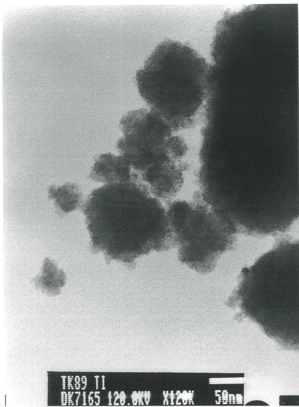
Figuur 3.6 Transmissie electronenmicroscopie-opname van uit titanylsulfaat vervaardigd \text{TiO}_2 .
