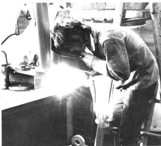
Bij laswerkzaamheden worden de ogen beschermd door de laskap en de handen door handschoenen.
