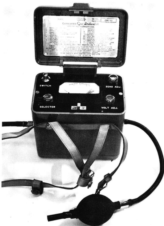
Meetapparaat voor het opsporen van explosieve gasmengsels.
