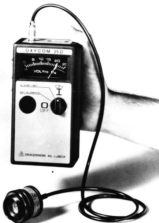
Apparaat voor het meten van het zuurstofgehalte in de lucht.
