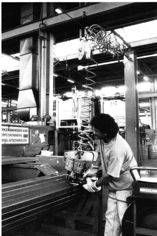
Het gewicht van het bindapparaat wordt gecompenseerd door de balancer
