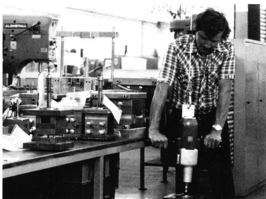
De balancer compenseert het gewicht van de boormachine
