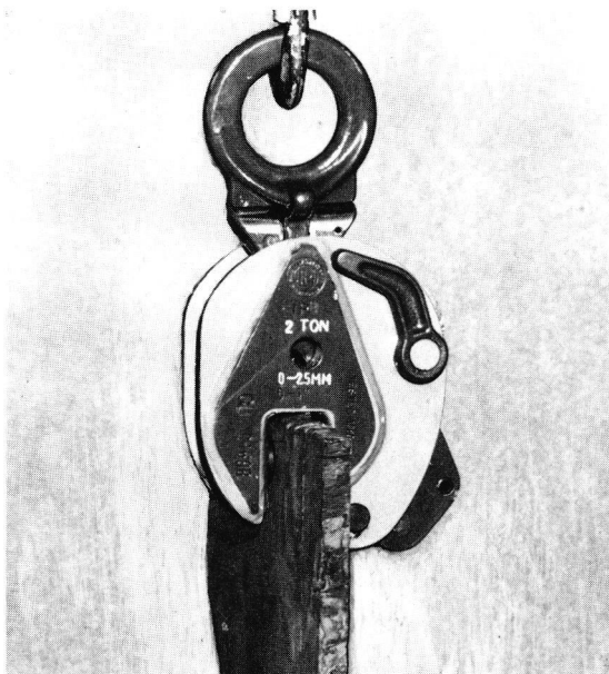
Hijsklem voor plaatstaal. Tijdens het hijsen moet de veiligheidshendel in de blokkerende stand staan.
