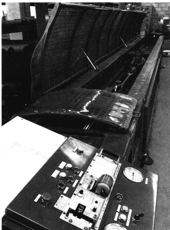
Trekbank voor het beproeven van hijsgereedschap.
