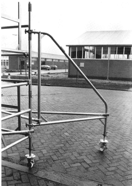
Driehoeks-stabilisator met in hoogte verstelbaar zwenkwiel.
