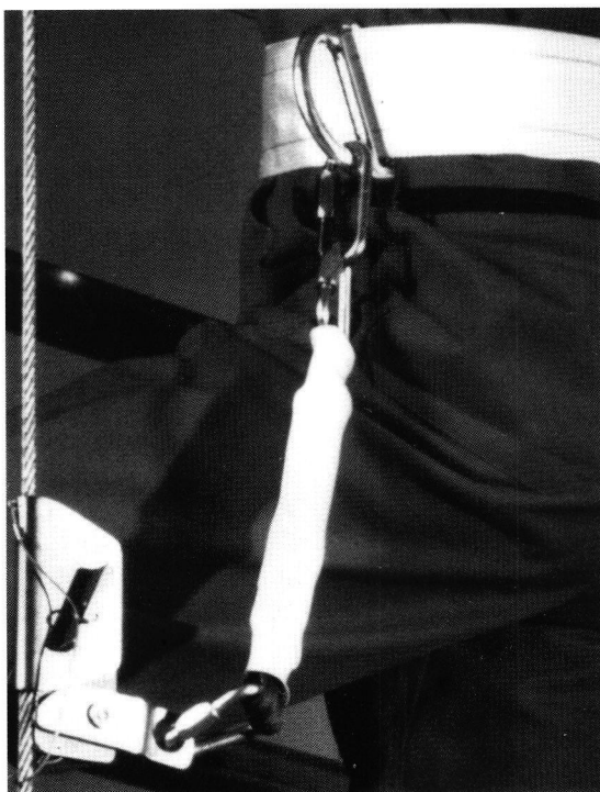
Schokdemper met samengestikte nylon band die bij een val uittornt
