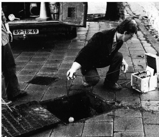
Vóórdat in de put mag worden afgedaald moeten eerst de concentraties van zuurstof, explosiegevaarlijk gas en zwavelwaterstof worden gemeten.
