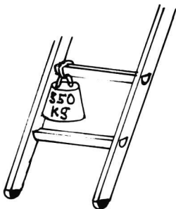
Het belasten op afschuiving van de bevestiging van sporten of treden aan de stijlen
