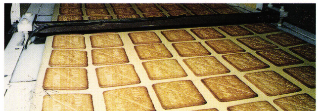
Figuur 3. Het meten van het vochtgehalte van biscuits op een afvoerband van een experimentele oven met behulp van een capacitieve sensor die over de band is geplaatst.
