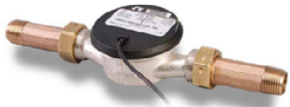
Figuur 4: Digitaal uitlezen van de waterstroom van bijvoorbeeld warmtapwater. Wanneer deze meter aangevuld wordt met temperatuursensoren kan de warmtestroom worden berekend.
