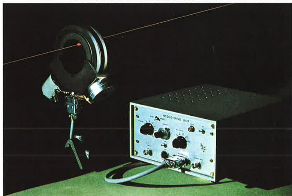
Afb. 1. Helderheidsregelaar met mogelijkheid tot opname in een terugkoppelketen.
