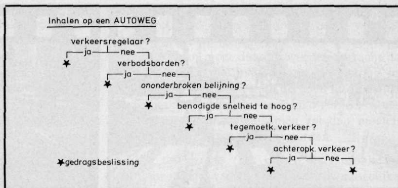
Afb. 3. Voorbeeld van een gedrags-schema van een chauffeur die wil inhalen op een autoweg
