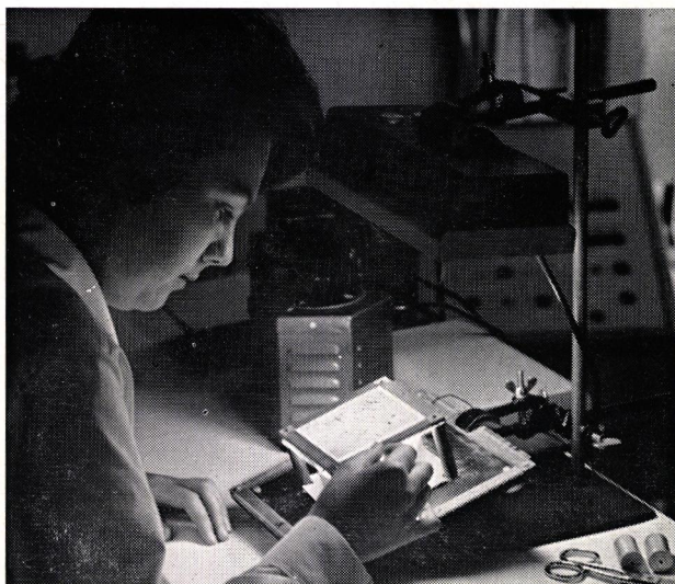
Fig. 5. Nieuwe taken, nieuwe eisen. Montage van geheugenmatrices. Directe bovenverlichting 2000 lux, onderverlichting 50 lux (archief Philips).
