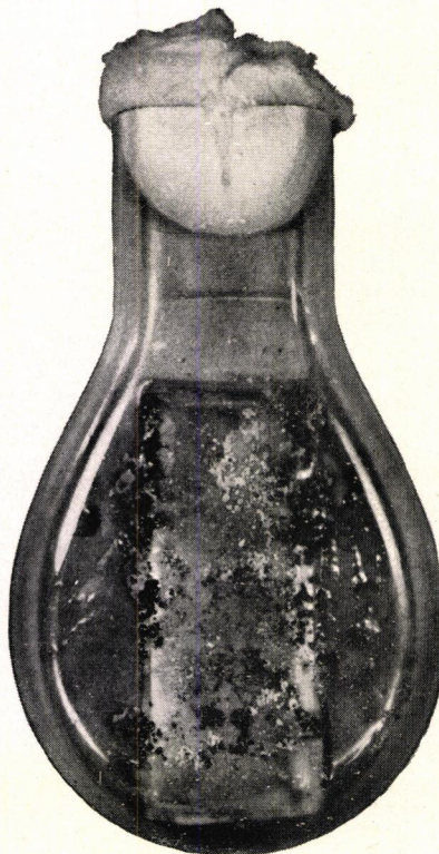
Fig. 5d. Het resultaat van veertien dagen kweken: het lapje is door de schimmel aangetast. (The result after another incubation period of 14 days: the fabric shows heavy fungus growth.)
