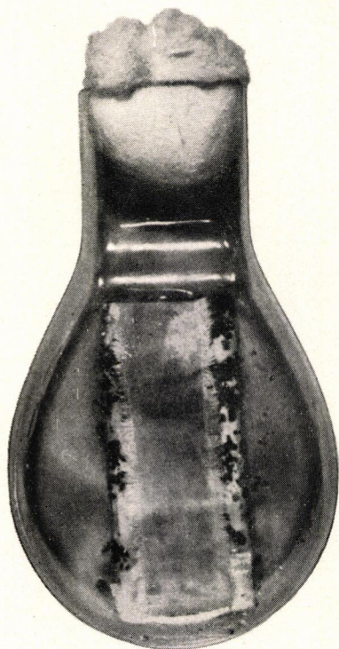
Fig. 5c. Op de schimmelmat is een weefselstrook geplaatst. (The same, after a strip of fabric has been placed on the mycelium mat.)
