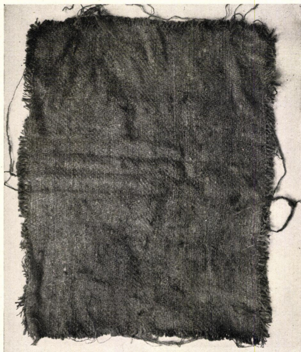
Fig. 4. Het nut van conservering. Resultaat van een begraafproef met jute zakkenstof.
