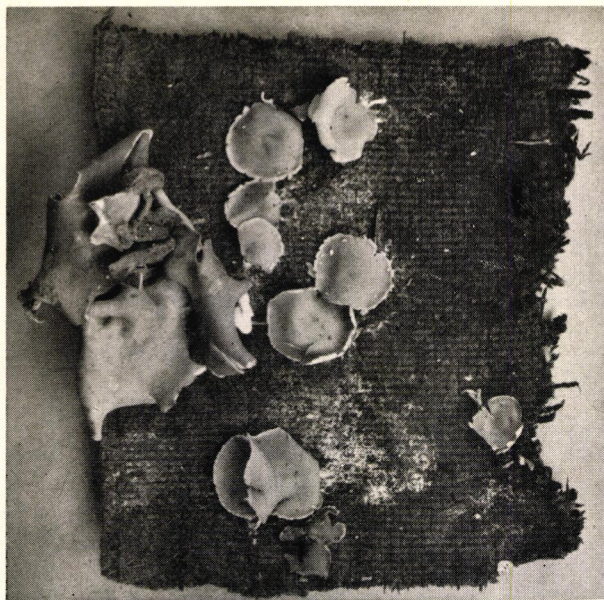
Fig. 2. Een extreem gevolg van aantasting : een vloerkleed, dat twee jaar opgeborgen was geweest in een vochtige schuur, vertoont zo'n sterke aantasting, dat er zich vruchtlichamen van een Aleuria -soort („paddestoelen” dus) op ontwikkeld hebben. Afmetingen van het gefotografeerde stuk circa 30 \times 30 cm.
