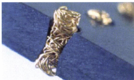
Close-up van de co-planaire CIN::APSE connectie
