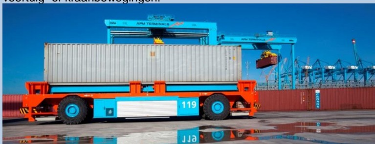
Figuur 3. Geautomatiseerde transportwagen op de APM-terminal Maasvlakte 2
