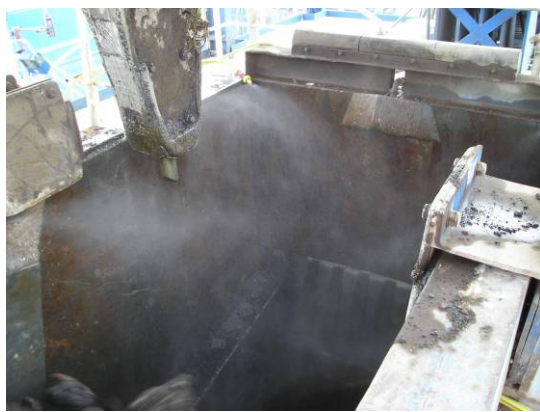
Kaakbreker met vlakstraal sproeier, druppelgrootte: 200 – 400 µm
