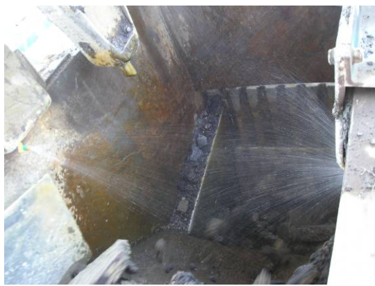
Kaakbreker met volkegel sproeier, druppelgrootte: 1000 – 2000 µm
