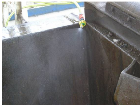
Kaakbreker met vlakstraal sproeier, druppelgrootte: 200 – 400 µm
