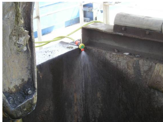
Kaakbreker met volkegel sproeier, druppelgrootte: 1000 – 2000 µm
