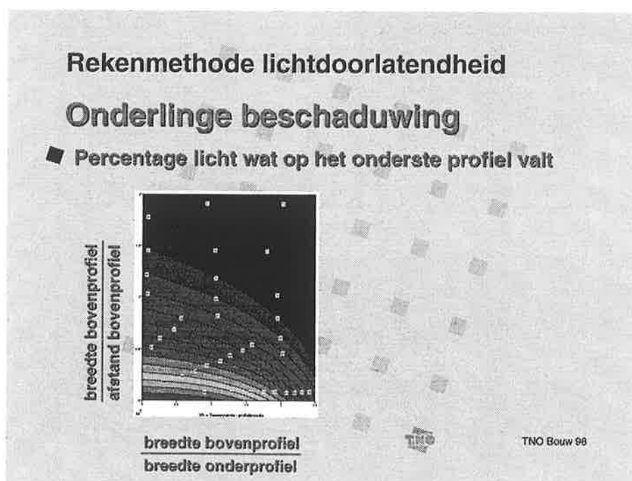
Figuur 3.9 De IDT-methode houdt rekening met onder elkaar liggende profielen, waarbij de onderste voor een deel door de bovenste van het licht wordt afgeschermd.
