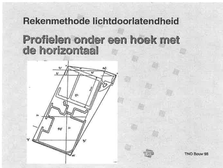
Figuur 3.7 Met de IDT-methode is het mogelijk constructiedelen die verdraaid zijn ten opzichte van het horizontale vlak, in de analyse mee te nemen.
