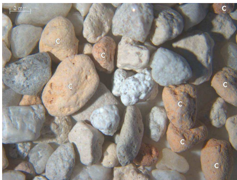
Fig. 10. Boven: toeslag uit mortels 4 en 5 van het Bisschoppelijk paleis. Onder: detail van de korrelfractie 2-4 mm in mortel 4. Fragmenten afgerond keramisch materiaal zijn met een C aangeduid.
