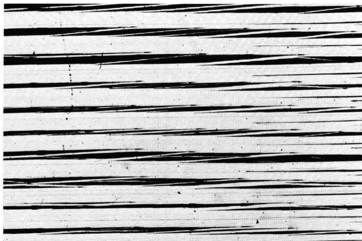
Fig. 4. Inslagpatroon van de naalden op een verstrekte folie (vergroting 10 x), v_n/v_f = 1,5 ; film iets gerekt in dwarsrichting.
