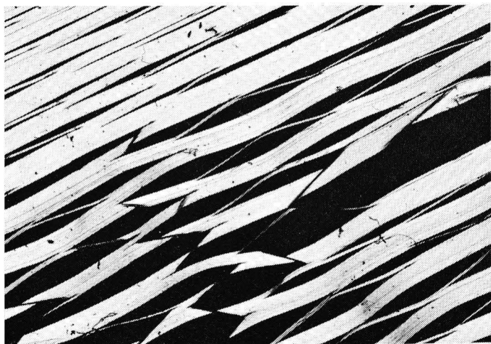
Fig. 5. Inslagpatroon van de naalden op een verstrekte folie (vergroting 10 x), v_n/v_f = 1,5 ; film in dwarsrichting iets meer gerekt dan in fig. 4.
