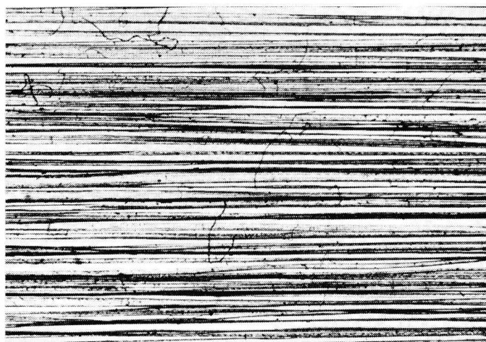
Fig. 11. Splijtvezels gemaakt met TNO-naaldwals (vergroting 21 x),
