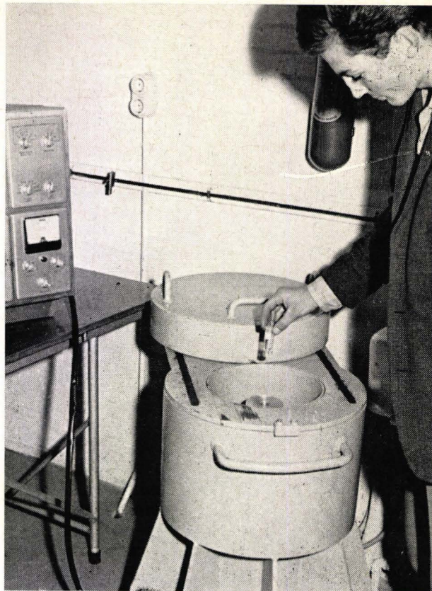
Fig. 5. Opstelling voor Well-counting.
