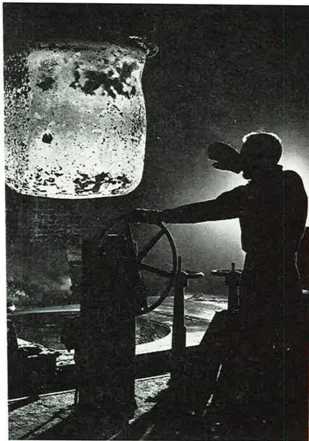
Mens en dummy Meting van de stralingsbelasting
