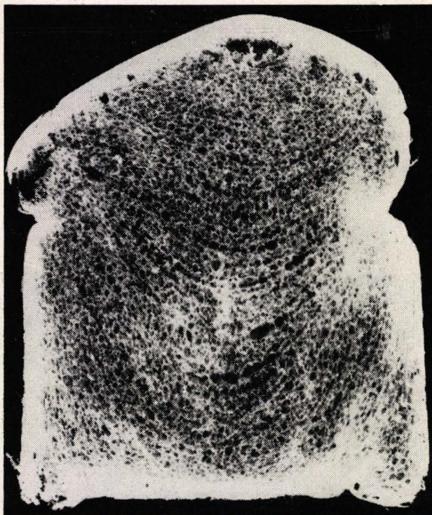
Fig. 8. Structuuroopname van een volgens continue werkwijze bereid brood. Let op de van de zij- nerven uitgaande strengen in het kruimskelet
