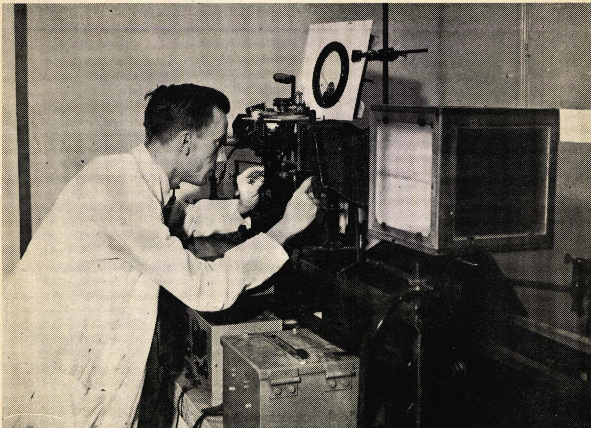
Fig. 3. Met behulp van de micro-oven, gecombineerd met fotografie-inrichting, is het mogelijk het bakproces van een uiterst dun deegfilmpje op zeer vergrote wijze op de gevoelige plaat vast te leggen.
