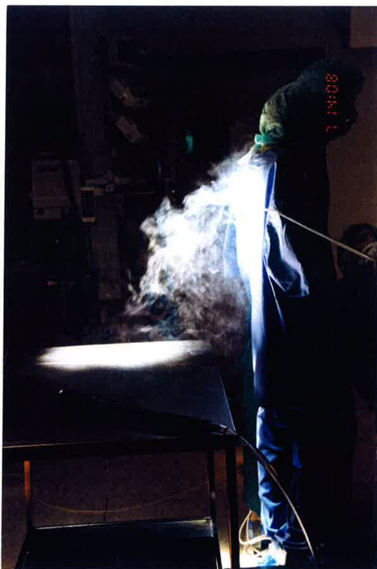
Figuur 1 Luchtwervelingen over de instrumenten tafel die zich onder een downflow-plafond, achter het operatiepersoneel bevindt.
