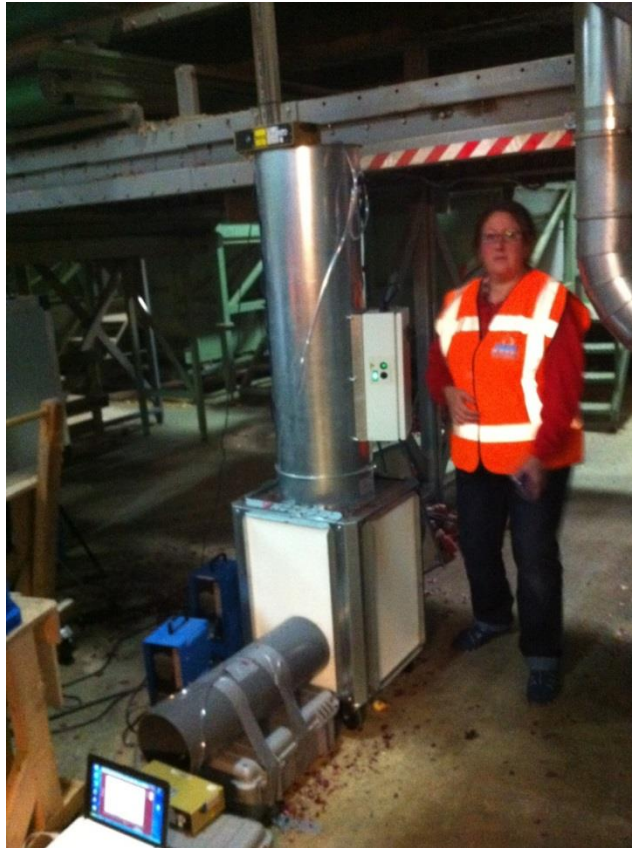
Figuur 5: ASPRA L mobile filterunit, bovenop de unit is de Grimm fijn stof meter zichtbaar, de andere fijn stof meter bevindt zich in de uitblaas van de donkergrijze meetpijp aan de onderzijde.
