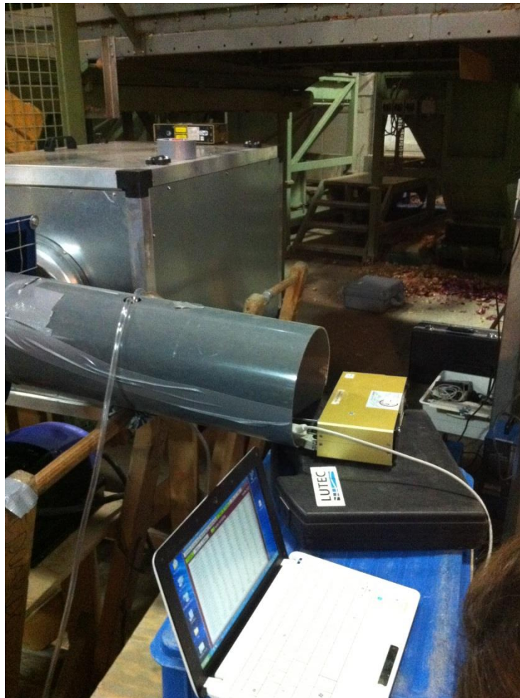
Figuur 4: Lutec filterunit circa 1 m boven de grond geplaatst, bovenop de unit is de Grimm fijn stof meter zichtbaar, de andere fijn stof meter bevindt zich in de uitblaas van de donkergrijze meetpijp op de centrifugaal ventilator.
