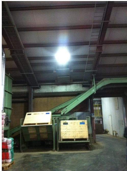
Figuur 6: Meetlocatie retourlucht Modesta ontstoffingsfilter, de eerste inblaasopening boven de kistenkantelaar is bemeten.
