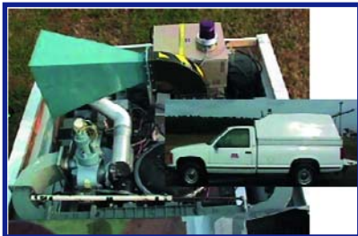
Figuur 2. HPM-systeem ingebouwd in een auto.
