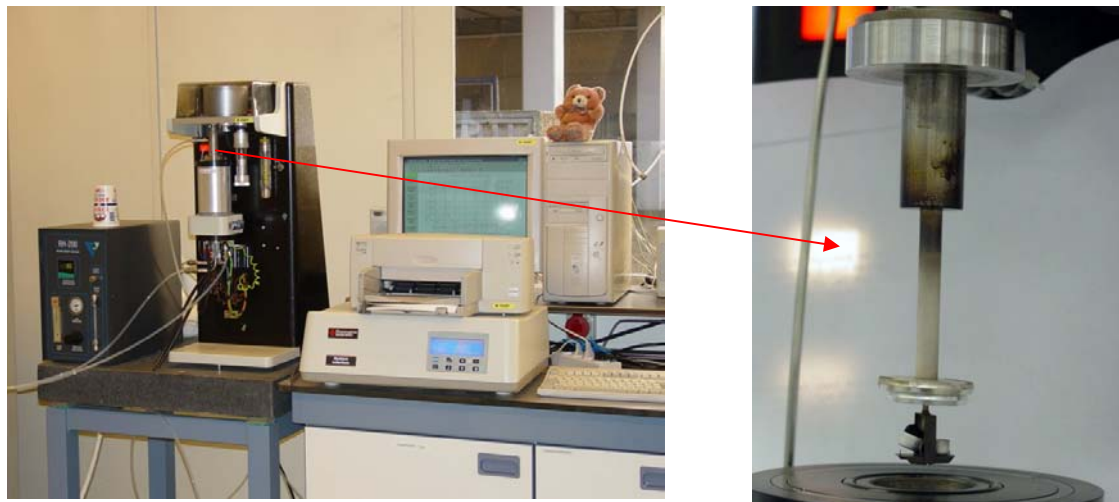
Figuur 5.2 Links het TGA apparaat, rechts uitvergroot de weegarm.
