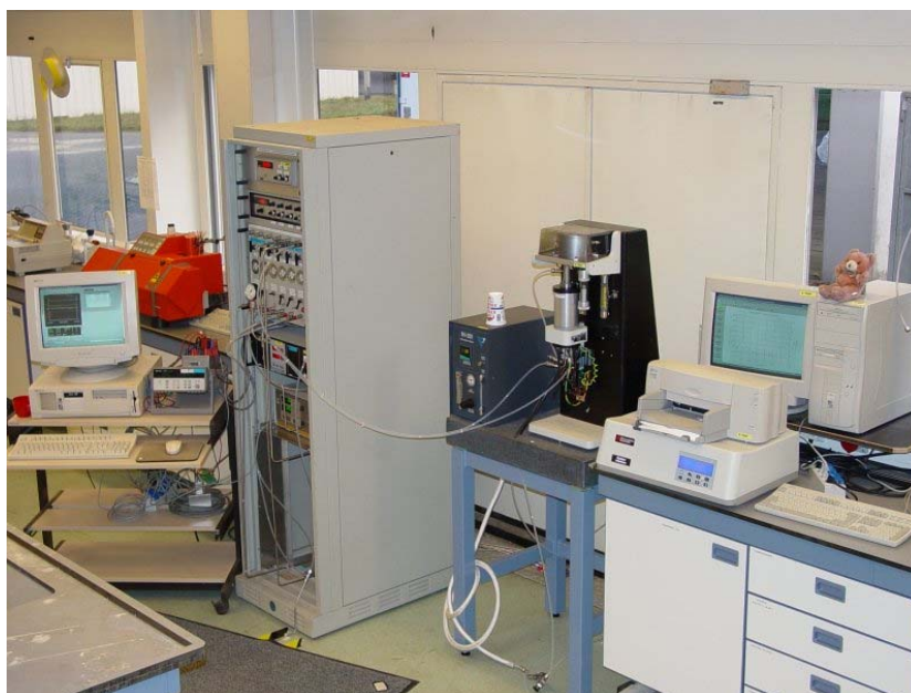
Figuur 5.1 De complete opstelling: gasanalyse-apparatuur + TGA.
