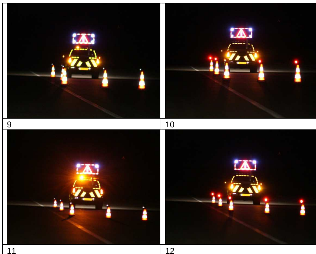
Figuur 6 Opstelling 2. Links: E-flares uit, rechts: E-flares aan, boven: 75 cm kegels, onder 50 cm kegels. Aanrijstrook 2 (rechter rijstrook). Afstand is 104 m. De getallen duiden op het nummer van de meting.
