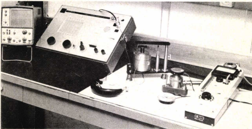
Opstelling voor het ijken van een audiometer
