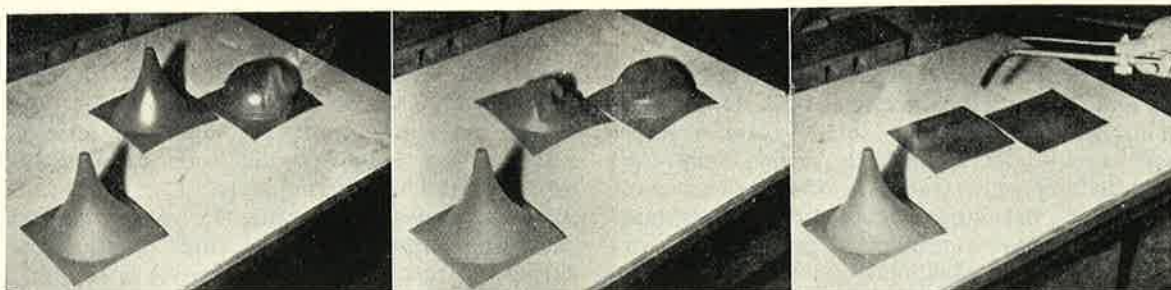
Afb. 4. Het geheugen van een vervormde plaat: a. De hete vlam nadert het bolvormige voorwerp. b. Door de warmte keren de bol en de trechter terug naar de oorspronkelijke toestand. c. Bol en trechter zijn teruggekeerd tot de oorspronkelijke plaatvorm.
