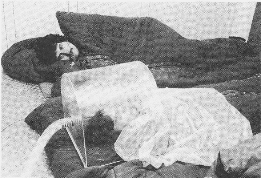
Fig. 3. Meting van het metabolisme tijdens het proefpersonenexperiment in de klimaatkamer.
