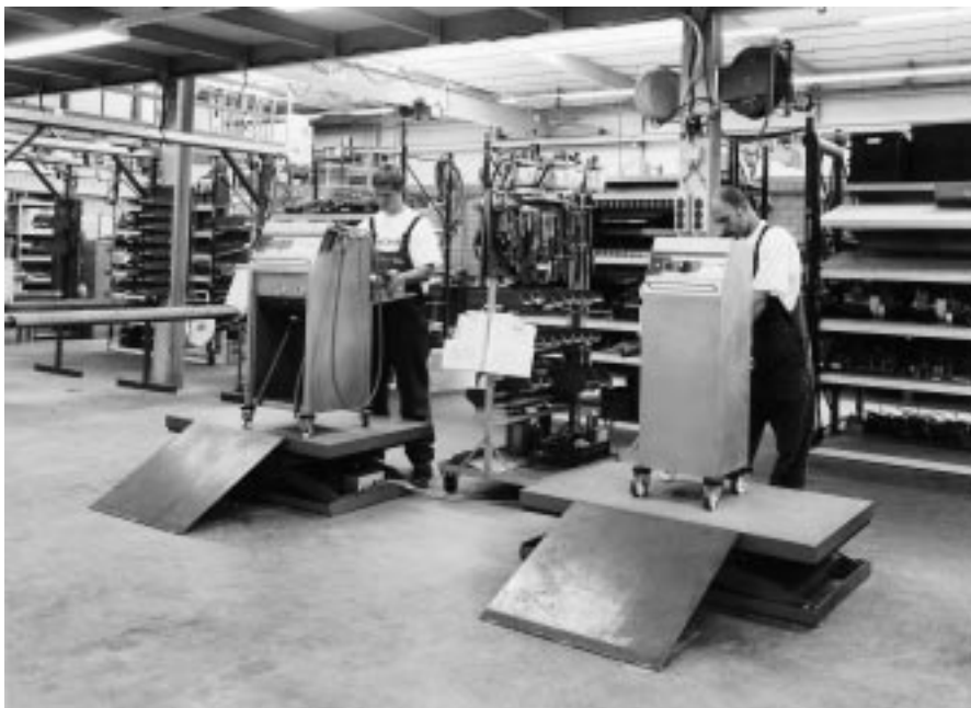
In de nieuwe situatie zorgen heftafels ervoor dat er altijd op de juiste hoogte gewerkt kan worden.
