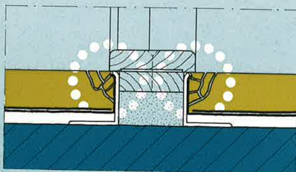
De stofdorpel heeft onvoldoende steun op de dekvloer (rand dekvloer brokkelt af!).
