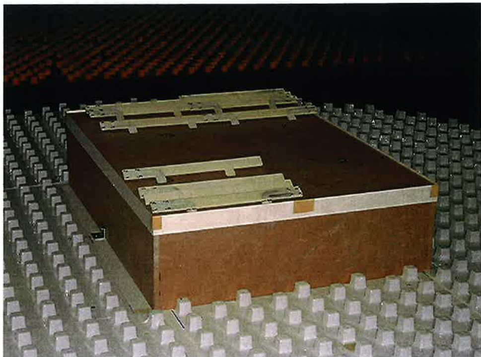
Foto B.8: Model voorzien van een dakrand; open constructie.
