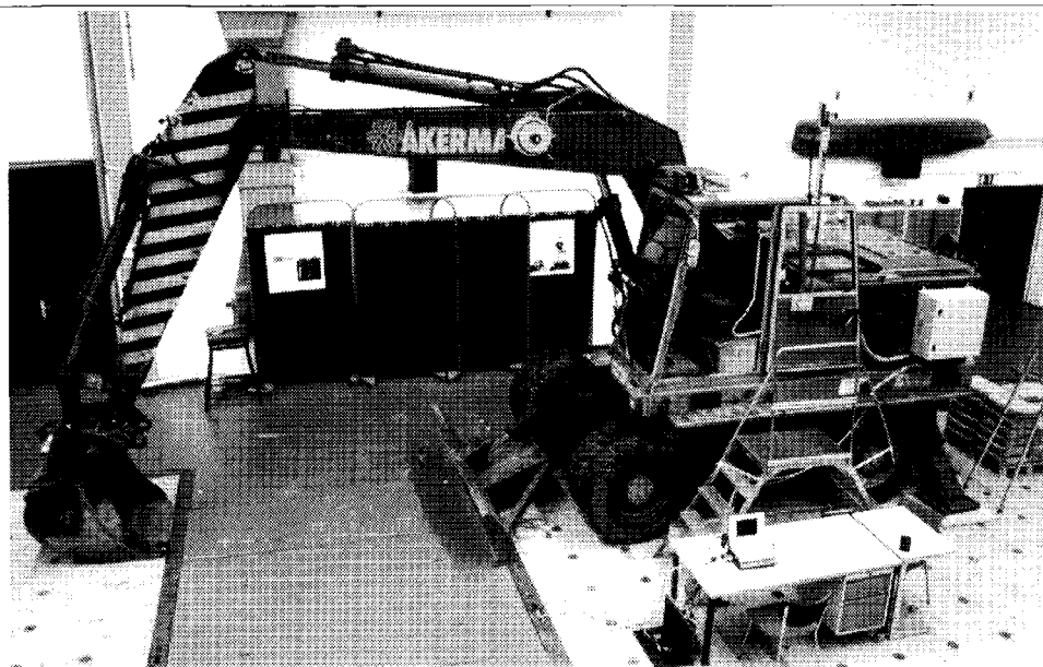
Figuur 3 Testopstelling voor computersturing van graafmachine-arm en sensorsysteem.
