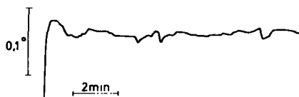
Fig. 2.2 Registratie van de gedeeltelijk gecompenseerde, versterkte thermospanning tijdens en na een temperatuursprong van 0,7^{\circ} , nadat de versterking was omgeschakeld van 10^4 naar 10^5 .
