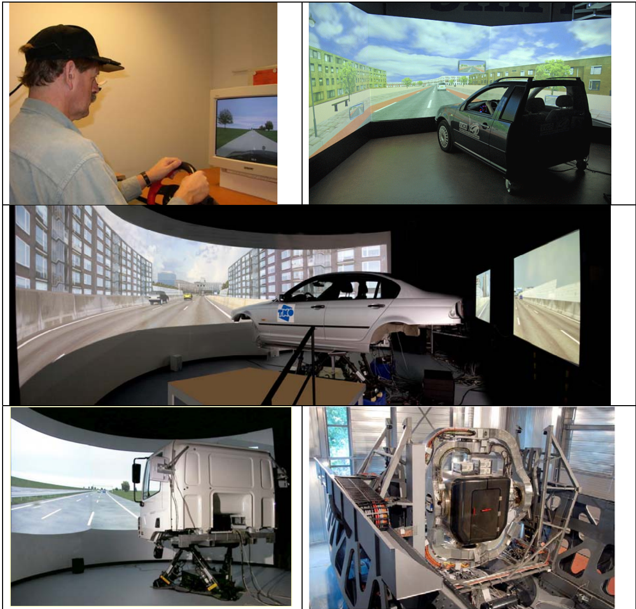
Fig. 9 Rijnsimulatorfaciliteiten bij TNO: Linksonder: De TNO rijnsimulator met truck cabine als mock-up; rechtsboven: Low-cost fixed-base rijnsimulator; midden: High-fidelity moving-base rijnsimulator opstelling; linksonder: Mini-simulator die ingezet wordt bij begrijpelijkheidsstudies; rechtsonder: Geavanceerd bewegingsplatform DESDEMONA dat zowel voor het simuleren van complexe vliegmanoeuvres als voor rijden in meer extreme situaties (scherpe bochten rijden, slalommen, van de weg raken, e.d.) kan worden ingezet.
