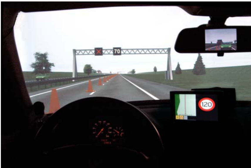
Fig. 14 Voorbeeld van het Wijzer op Weg in-car systeem in de TNO rijsimulator en het scenario Werk-in-uitvoering.
