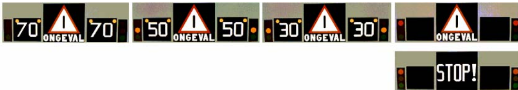
Fig. 13: De stopvariant, waarbij elke combinatie borden gedurende 10s werd getoond. De laatste twee borden ("Stop" en "Ongeval") alterneerden.
