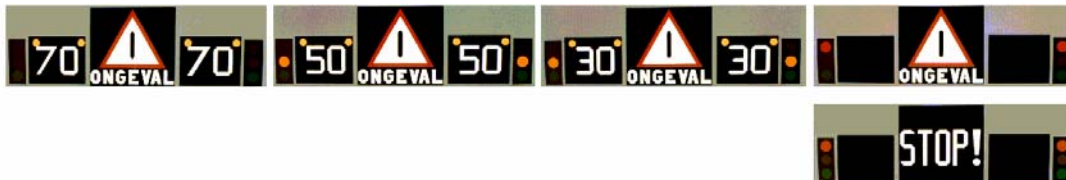
Fig. 11: De stopvariant, waarbij elke combinatie borden gedurende 10s werd getoond. De laatste twee borden ("Stop" en "Ongeval") alterneerden.
