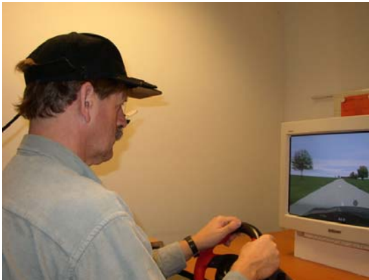
Fig. 2 Mini-simulator die ingezet wordt bij begrijpelijkheidsstudies.
