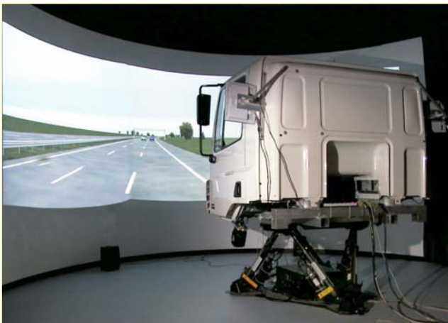
Fig. 7 De TNO rij simulator met truck cabine als mock-up.
