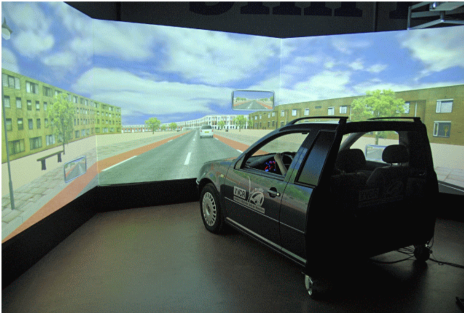
Fig. 3 Low-cost fixed-base rijnsimulator bij TNO.
