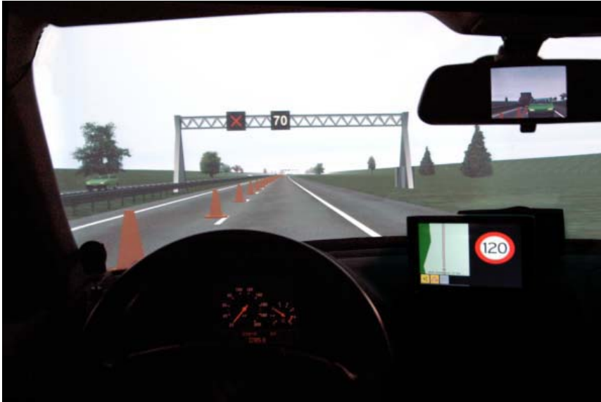
Fig. 12 Voorbeeld van het Wijzer op Weg in-car systeem in de TNO rijnsimulator en het scenario Werk-in-uitvoering.
