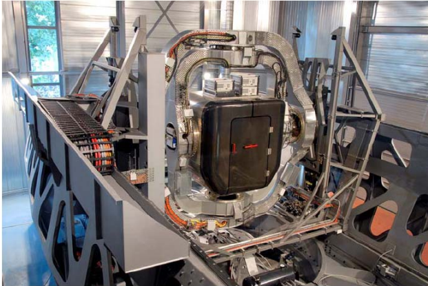
Fig. 5 Geavanceerd bewegingsplatform DESDEMONA dat zowel voor het simuleren van complexe vliegmanoeuvres als voor rijden in meer extreme situaties (scherpe bochten rijden, slalommen, van de weg raken, e.d.) kan worden ingezet.
