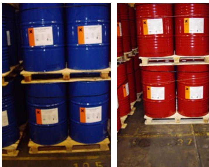
Figuur 2: blauwe tanks voor polyolen, rode tanks voor isocyanaten
