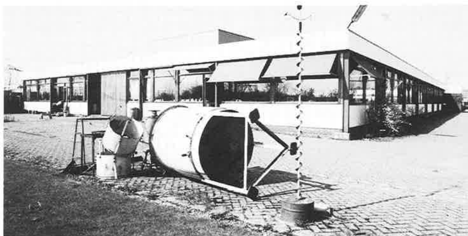
Het Proefstation aan de Rouaanstraat in Groningen. Op de voorgrond een kleinere reactor, waarmee voor een van de Avebe-fabrieken het anaerobe zuiveringsproces in de praktijk (met succes) is getest.
