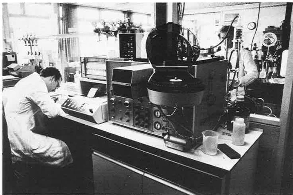
Een van de ingenieuze apparaten, waarmee in het Proefstation wordt gewerkt, is de z.g. „snuffelaar“, die van monsters afvalwater de stank meet.
