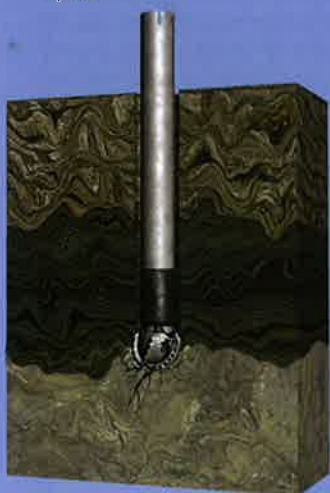
Boorkop kan vastlopen op een zoutlaag.
