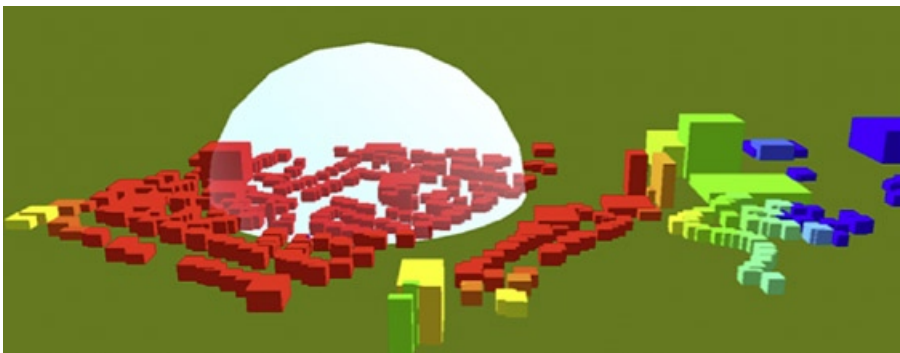
Figuur 4 Berekening van de schadezones in een realistisch scenario voor een explosie in een concrete stedelijke omgeving; het gebruikte CityNL-model is ontwikkeld in dit TNO-onderzoeksprogramma (rood = gebied met menselijke slachtoffers, blauw = gebied zonder schade)
