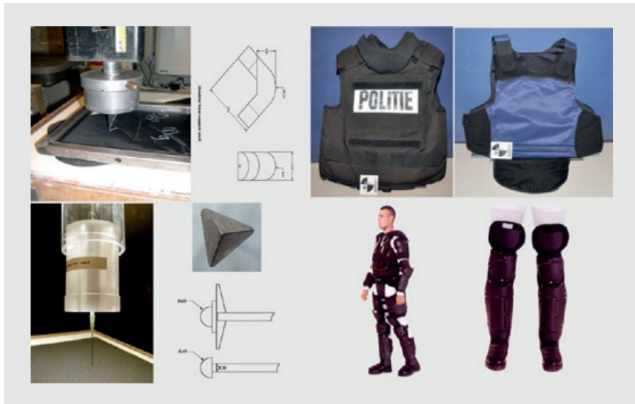
Figuur 19 Proefopstelling actieve of adaptieve slag-stootbescherming. Op verschillende manieren wordt bekeken of de materialen afdoende bescherming bieden voor slag-stootsituaties: zo is met de links getoonde testopstelling aangetoond dat bepaalde standaarduitrustingscomponenten niet bestand zijn tegen een messteek.
