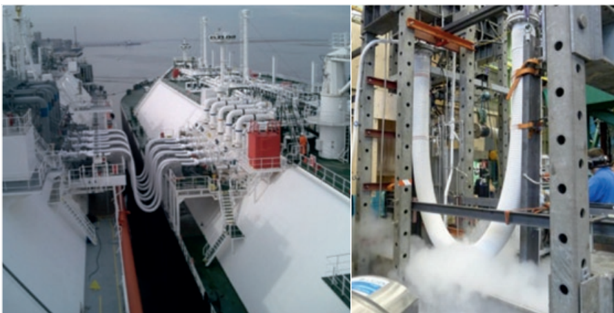
Figuur 8 Overslag van LNG vindt plaats via flexibele slangen. Foto rechts: installatie voor het testen van het bezwijkgedrag en het vaststellen van faalfactoren voor in de praktijk gebruikte slangen.
