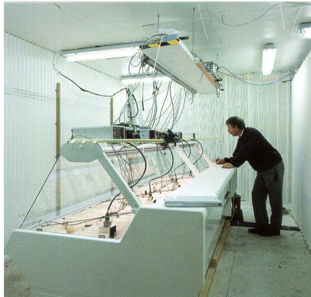
Foto 32 Keuring van een koelvitrine in één van de klimaatcellen door Gerrit van Laar
