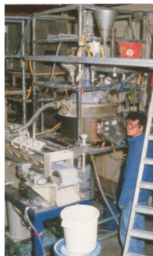
Foto 60 Terugwinnen van metalen uit ontzwavelingskatalysatoren met Joep Koene
