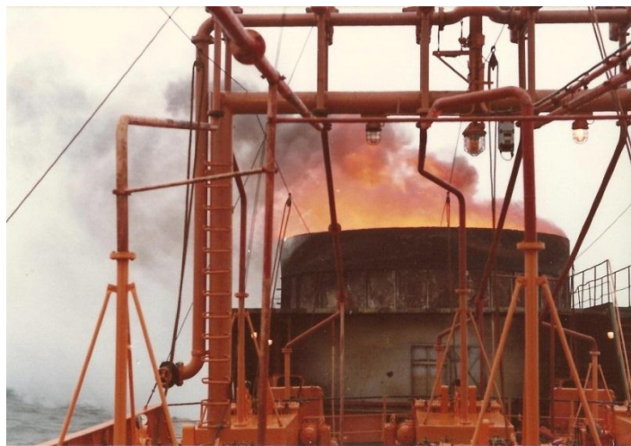
Foto 47 De afvalverbrandingsoven aan boord van het schip
