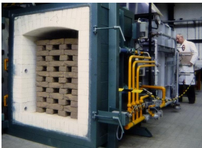
Foto 67 Jan van der Velden achter de beproevingsoven voor bakstenen 1983
