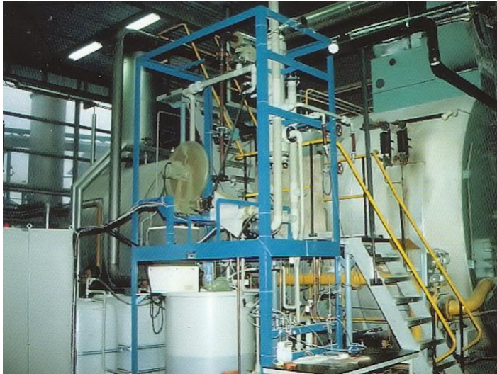
Foto 56 Proefopstelling voor het verwijderen van SO 2 uit rookgas
