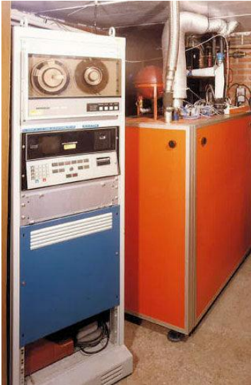
Foto 64 Praktijkonderzoek van warmtepomp voor woningverwarming in woning van collega Jos Bouma in de Apeldoornse wijk de Maten
