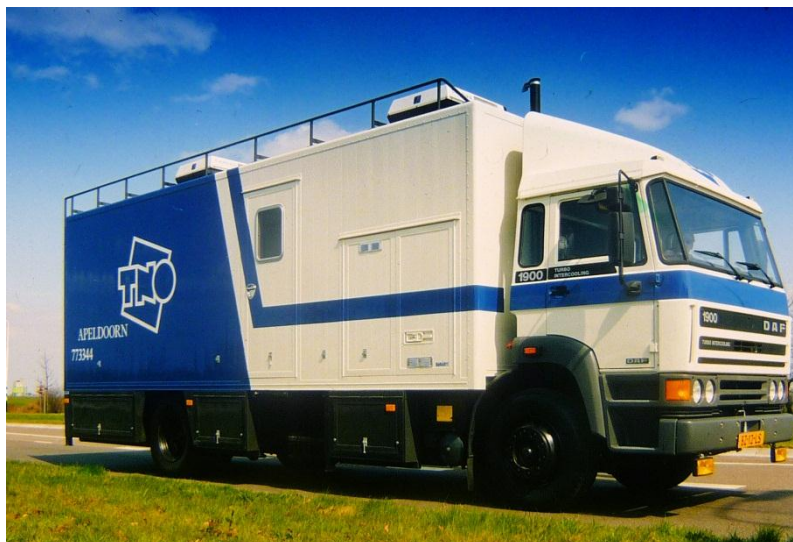
Foto 50 De meetauto voor metingen aan verbrandingsinstallaties
