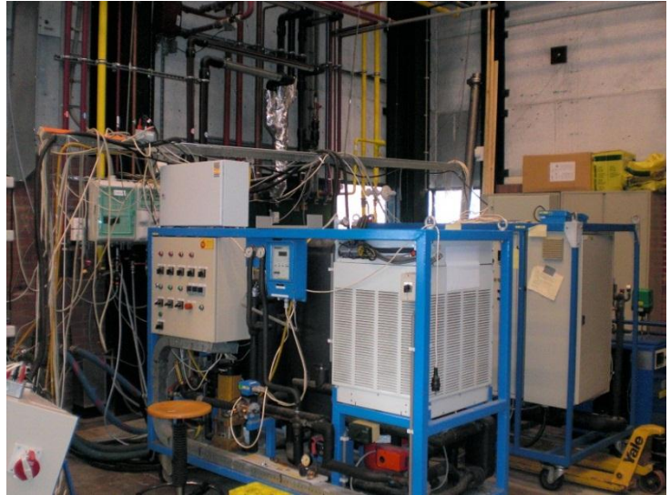
Foto 65 Proefstand voor het instellen van omgevingscondities voor warmtepomp-onderzoek
