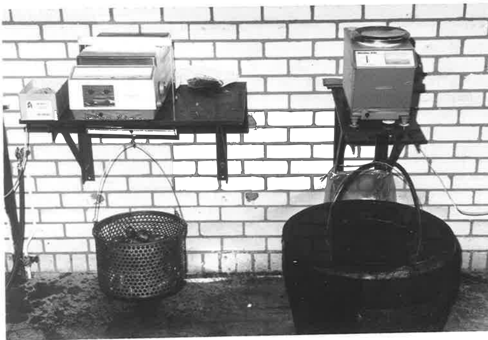
Zetmeelbepaling door weging van ca. 5 kg aardappelen en daarna weging van het zelfde monster onder water.
