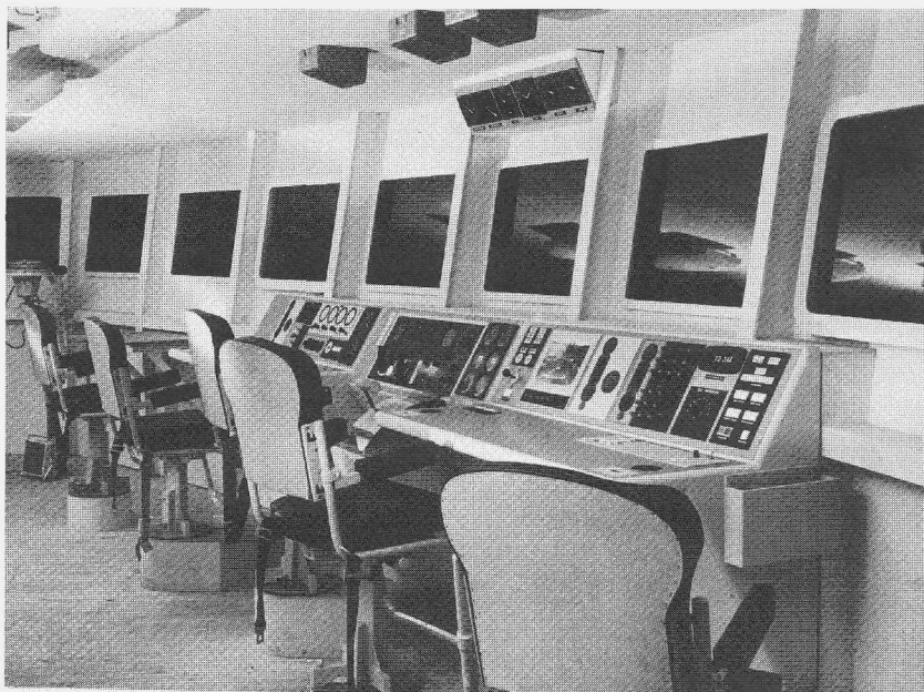
Door het IZF ontwikkelde Mock-up van de navigatiebrug voor de nieuwe fregatten van de Marine (1970).
