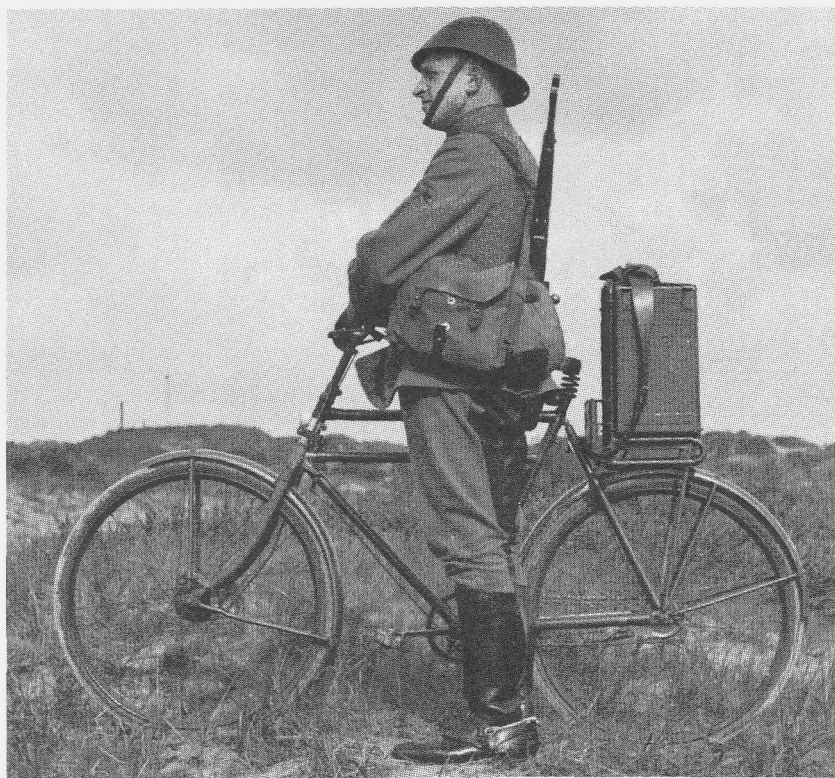
Zend-ontvanger geschikt voor fietstransport voor gebruik op compagnie-niveau.
