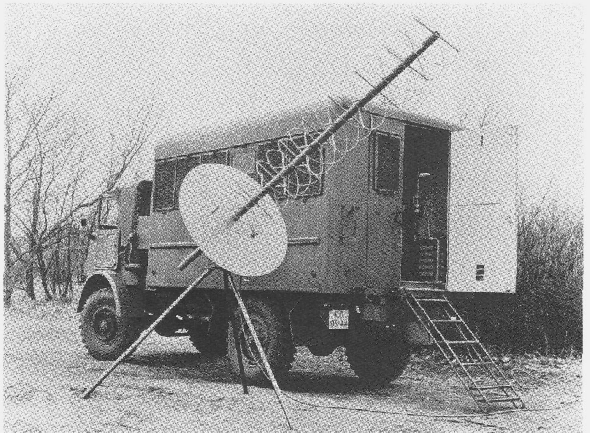
Mobiele opstelling van een experimentele tactische satellietcommunicatie-post met spiraalantenne (Fysisch Laboratorium 1968).
